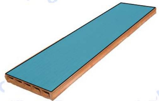
La cara marcada es la de apoyo, perpendicular a la cual se aplicará la carga para realizar el ensayo de resistencia a flexión.
